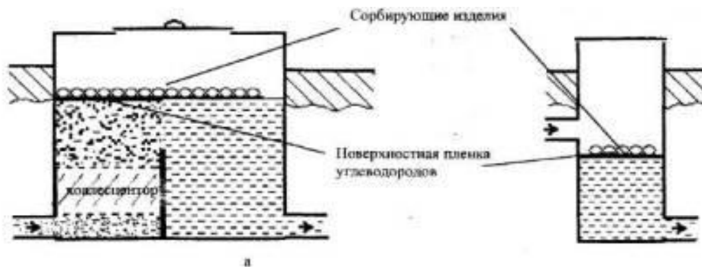
Мал. 10. Використання сорбуючих виробів у відстійниках (а) та колекторах (б) стічних вод
